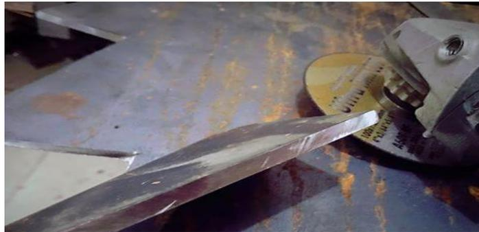
Gambar 4.7 Proses penghalusan bidang sisi
