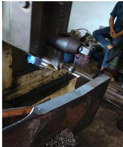
Gambar 4.8 Proses pemakanan sisi kiri dan kanan
