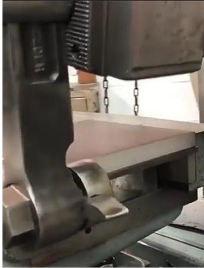
Gambar 4.9 Proses pemakanan sisi atas dan bawah
