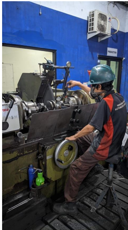
Gambar 2. 6 Proses Pengerjaan crankshaft pada mesin Cylindrical Grinding (Dokumen Pribadi. 2022)
