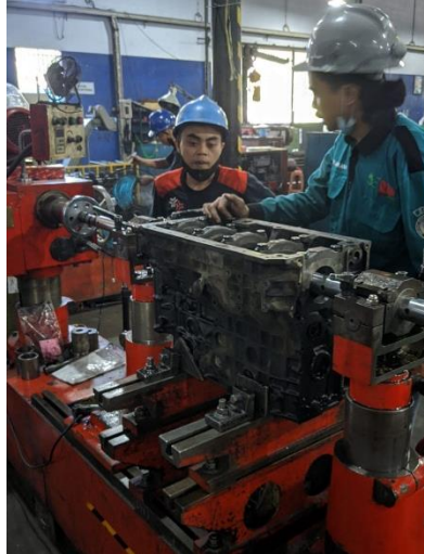
Gambar 4. 4 Proses finishing pada divisi Line Boring (Dokumen Pribadi.2022)
