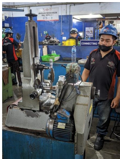
Gambar 2. 8 Mesin Boring Connecting-Rod (Dokumen Pribadi. 2022)
