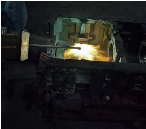
Gambar 4. 1 Proses Pemanasan awal pada blok mesin canter ps 125
