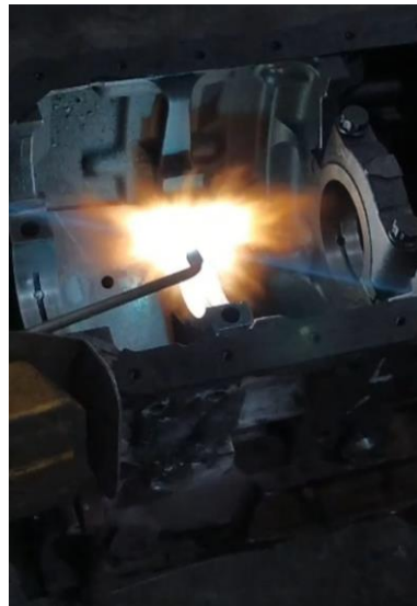
Gambar 4. 3 Proses pemanasan guna penyatuan serbuk Castoline Eutectic (Dokumen Pribadi. 2022)
