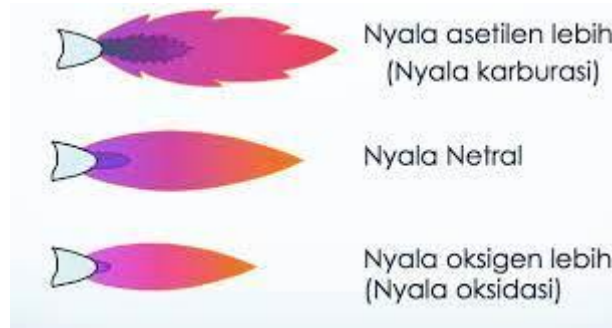
Gambar 4. 5 Macam Nyala Api pada Las OAW (www.pengelasan.net. 2022)
