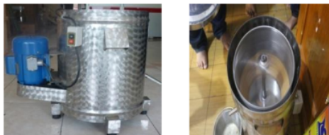
Gambar 1. Alat Peniris Metode sentrifugas dan pengoperasionalnya
