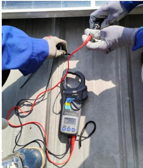
Gambar 3.17 Melakukan Pengukuran Tegangan Bocor
