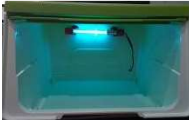
Gambar 4. Alat Sterilisasi Sinar UV C Skala Laboratorium Hasil Riset Oleh Tim Pengabdian Sebagai Media Uji Pembuktian Keberhasilan Metode Untuk Permasalahan Mitra
