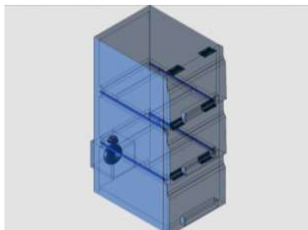
Gambar 6. Desain 3D Rencana Alat Sterilisasi Pengembangan Lanjutan Yang akan Diberikan ke Mitra
