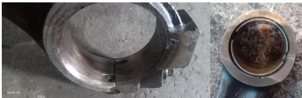
Gambar 4.2 Keausan pada Stang Piston (Dokumen Pribadi, 2020)
