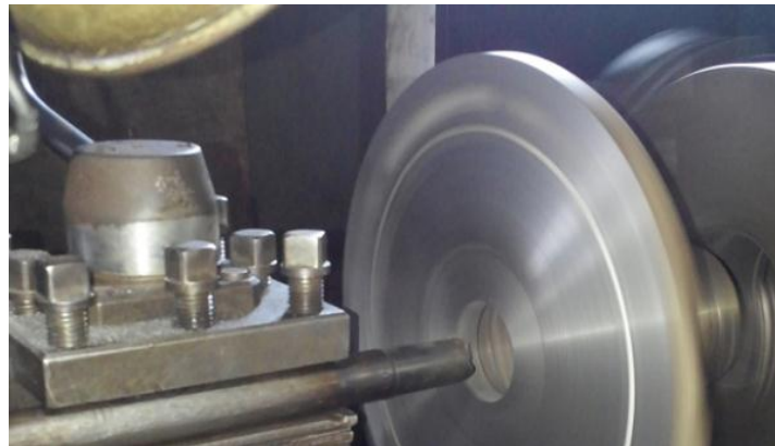
Gambar 3.11 Proses Pembubutan Sparator (Dokumen Pribadi, 2020)
