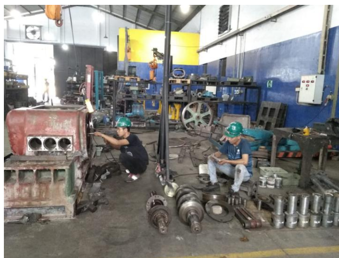
Gambar 3.8 Perawatan Mesin Dosing Pump (Dokumen Pribadi, 2020)
