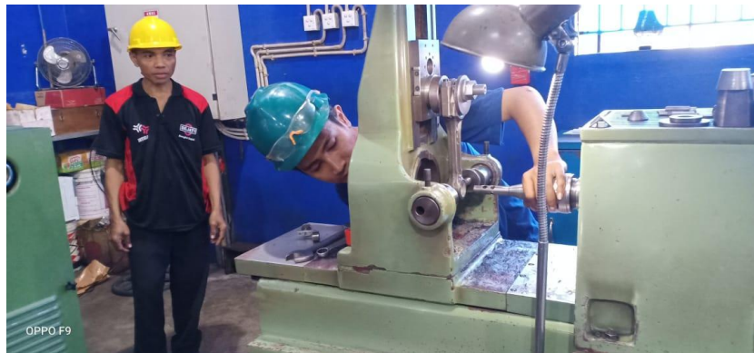
Gambar 4.3 Proses Restorasi Stang Piston (Dokumen Pribadi, 2020)
