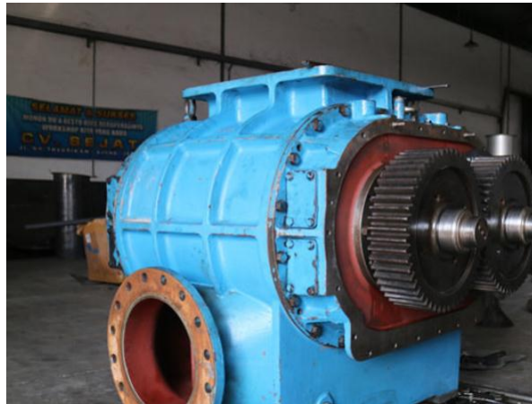
Gambar 3.3 Root Blower (Dokumen Pribadi, 2020)
