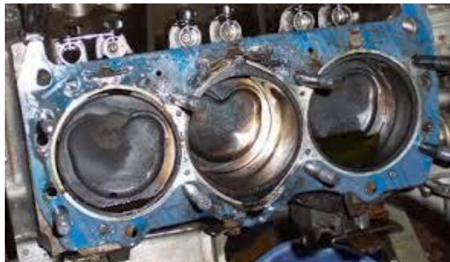
Gambar 5.2 Cylinder Block yang Tidak Rata (Dokumen Pribadi, 2020)
