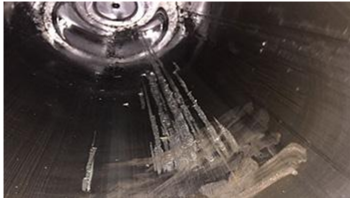
Gambar 5.1 Cylinder yang Mengalami Keausan (Dokumen Pribadi, 2020)
