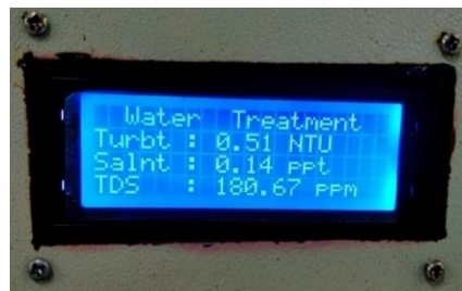
Gambar 4. 14 Hasil Pengukuran Kualitas Filtrasi Air PDAM Menggunakan Sensor
