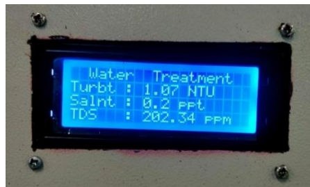
Gambar 4. 16 Hasil Pengukuran Kualitas Air Payau Menggunakan Sensor
