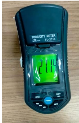
(c) Hasil Pengukuran Dengan Turbidity Meter
