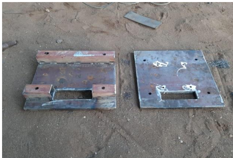
Gambar 4.11 Table Motor Penggerak dan Transmisi (Dokumen Pribadi, 2020)
