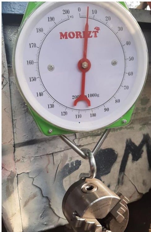
Gambar 4.9 Pengukuran Berat Chart (Dokumen Pribadi, 2020)
