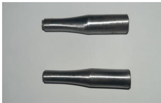
Gambar 4.23 Patahan Spesimen Bertakik (Dokumen Probadi, 2020)
