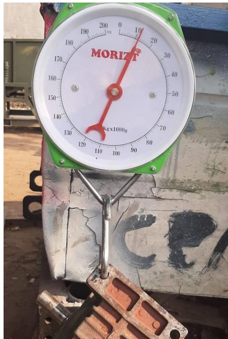
Gambar 4.7 Pengukuran Berat Transmisi 2 (Dokumen Pribadi, 2020)
