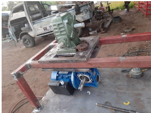
Gambar 4.12 Pemasangan Trasmisi (Dokumen Pribadi, 2020)
