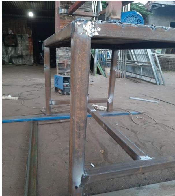
Gambar 4.10 Proses Pengelasan Rangka Alat Uji (Dokumen Pribadi, 2020)
