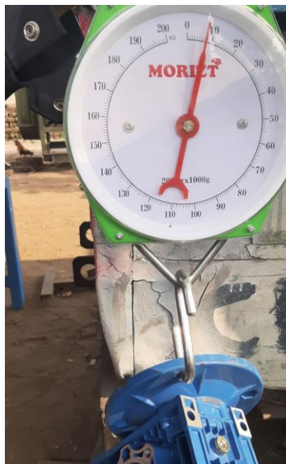
Gambar 4.6 Pengukuran Berat Transmisi 1 (Dokumen Pribadi, 2020)
