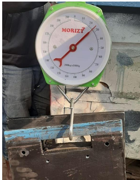
Gambar 4.5 Pengukuran Berat Table (Dokumen Pribadi, 2020)
