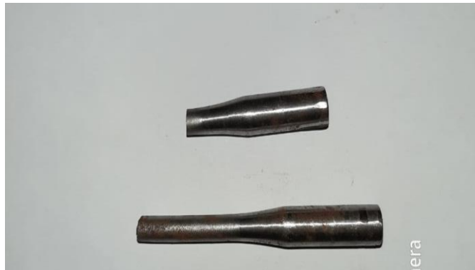
Gambar 4.25 Patahan Spesimen Tanpa Takik (Dokumen Pribadi, 2020)
