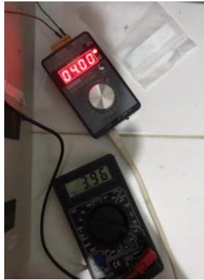
Gambar 1.3-4 Pengujian Sensor Arus dengan sinyal Generator
