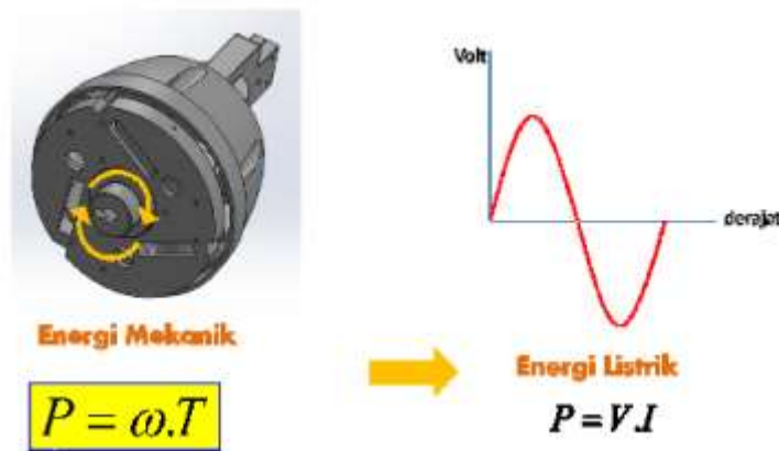
Gambar 2.1.3-5 Skema Konversi Energi Mekanik Menjadi Energi Listrik (Bachtiar, 2018)
