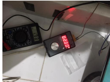
Gambar 1.3-2 Pengujian Sensor Tegangan dengan sinyal Generator
