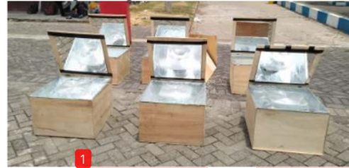
Gambar 3. Kompor Surya Tipe Kotak dengan Variasi Sudut Ruang Masak
