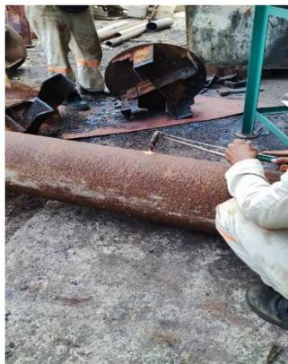
Gambar 3. 3 Proses Pematangan Tabung Pembuatan *Exhaust*
