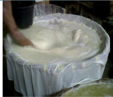
Gambar 2. Pengadukan pada proses penyaringan
