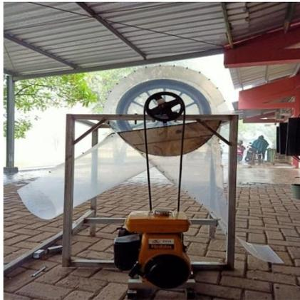
Gambar 2. 2 Mesin Pemipil Jagung Mekanis
